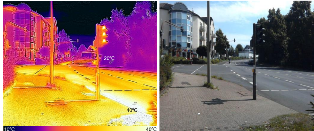
Abb.: Rechts eine Straßenansicht von der Friedrich-Goetze-Straße, links ein Thermobild derselben Stelle, Quelle: Büro Happold
